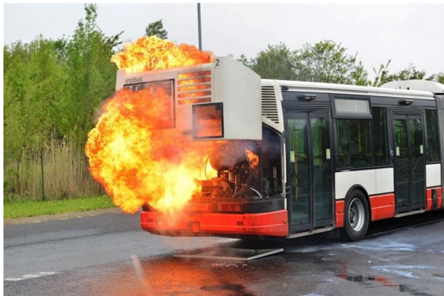
Plameny umělého požáru, které vydatně krmil kyslík, měly několik metrů (z fotografie jsou odstraněny identifikační znaky autobusu). | foto: DPP
